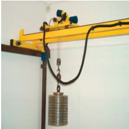
Rys. 1. Model suwnicy pomostowej Fig. 1. Model of the bridge-gantry
